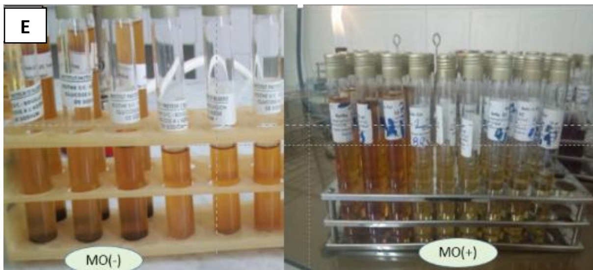
Démonstrations des quelques dénombrement des Coliformes totaux(C), fécaux et E.coli (D) et Streptocoques totaux et fécaux (E) de l'eau analysée. MO (+) en présence du Moringa, MO(-) en absence du Moringa ( Photos prise lors du stage ).
